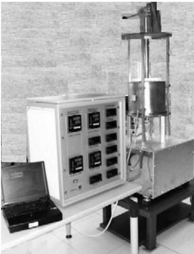
Fig. 6.- Equipo completo desarrollado constituido por el horno, el sistema de control de temperaturas y el programa para el control de los ensayos y la toma de datos.
